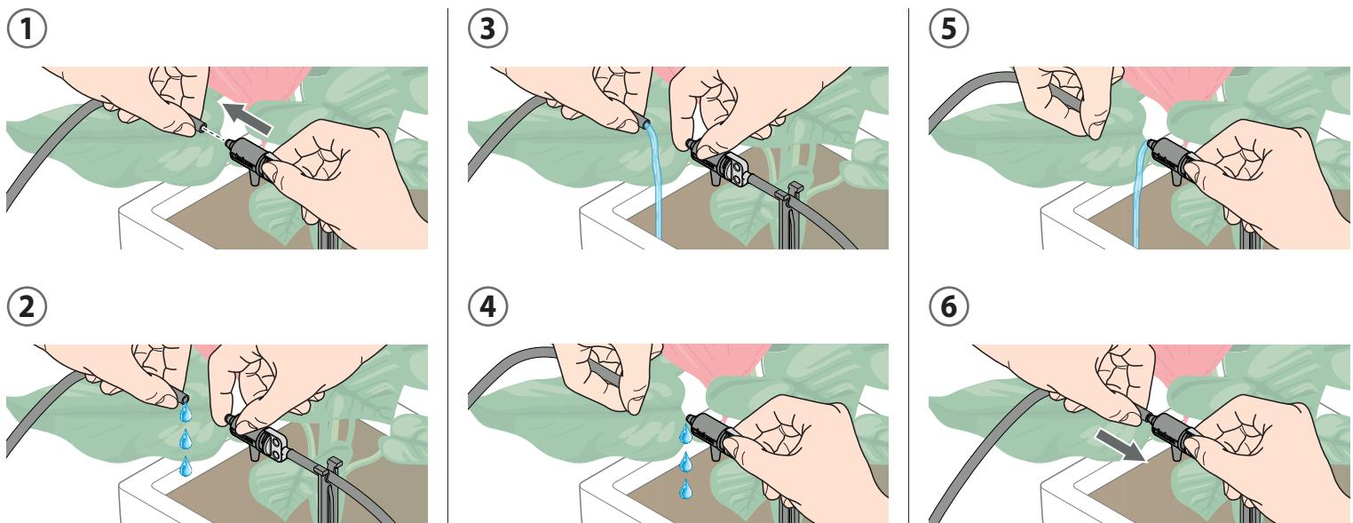
**IT PULIZIA DEL FILTRO.** La rimozione e il reinserimento del filtro devono avvenire con il serbatoio vuoto. Prima di ogni utilizzo controllare lo stato del filtro ed eliminare eventuali impurità dell'acqua trattenute dalla rete filtrante. Se fosse necessario rimuoverlo e sciacquarlo sotto l'acqua corrente.
